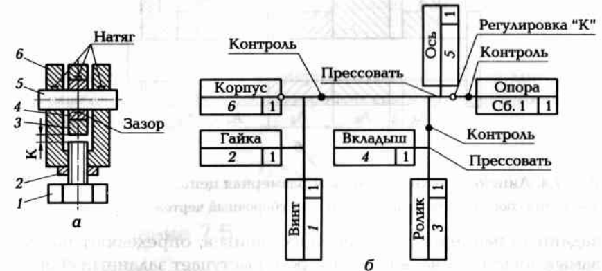
Рис. 7.3. Сборочный чертеж изделия «опора» (а) и схема сборки (б)
